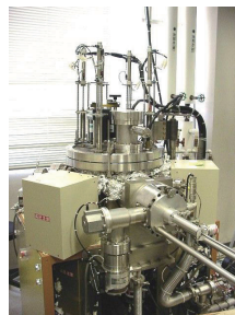
超高真空対応カールセル型スパッタリング装置
