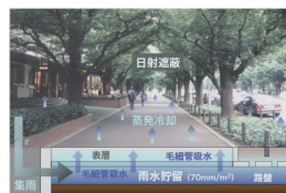
図 蒸発冷却舗装システムの基本構成と適用空間イメージ
